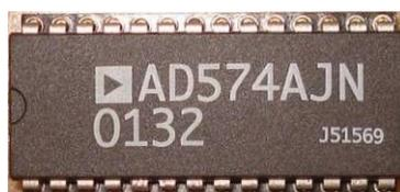
Figura 3: Dispositivo CAD AD574A da Analog Devices.
