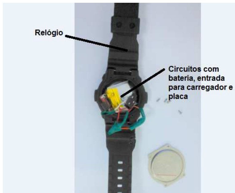
Fig. 5. Circuitos inseridos em uma pulseira de relógio comercial
